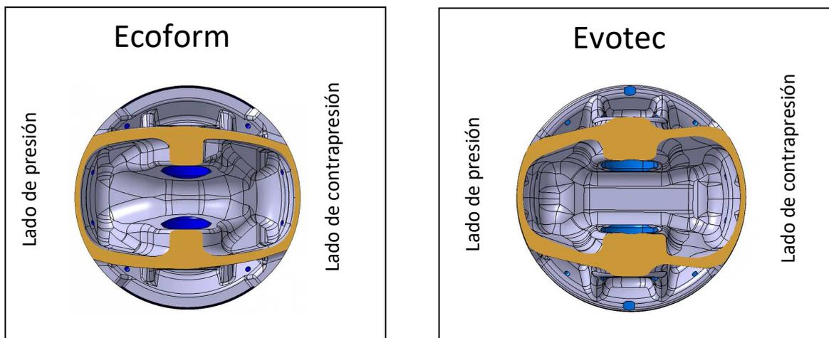
Nota: Los pistones MAHLE mencionados anteriormente pueden aplicarse a vehículos siguiendo el lado de montaje indicado en la parte superior sin ningún problema, daño o durabilidad para el motor.
