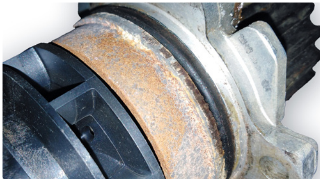
Figura 1: Rastros de corrosión en la bomba de refrigerante
