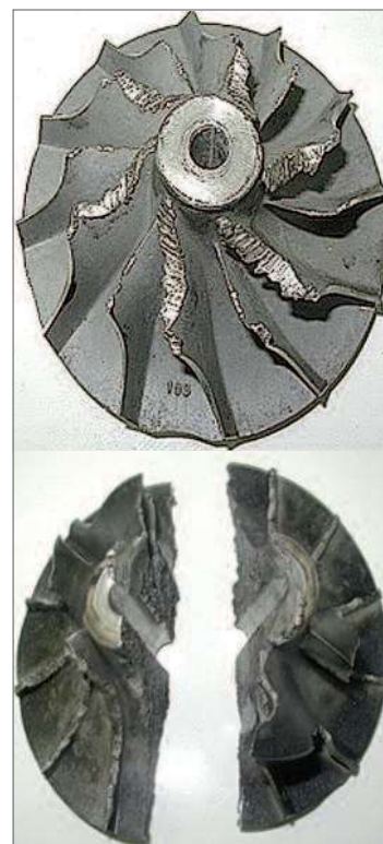
Fig. 13.2.2 – Rueda compresora con marcas de impurezas
