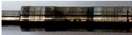
Fig. 13.1.2.2 – Rayas en el eje del rotor
