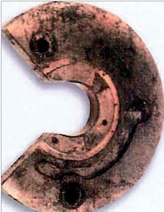
Fig. 13.3.1 - Contaminación de la bancada axial
