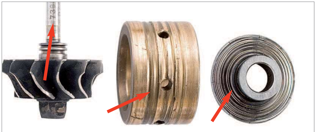
Fig. 13.1.1.5 - Eje del rotor, bancada radial y espaciador
