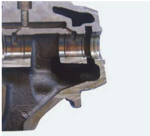
Fig. 13.1.2.3 – Rayas en el alojamiento de la bancada en la carcasa
